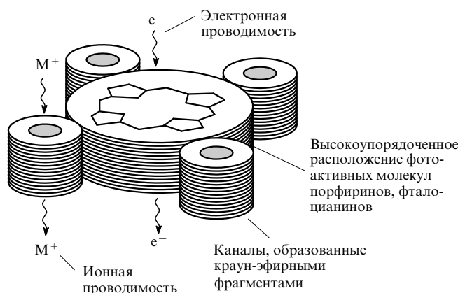
Рис. 19. Схематическое изображение упорядоченного супрамолекулярного ансамбля на основе краун-фталлоцианинов металлов.
